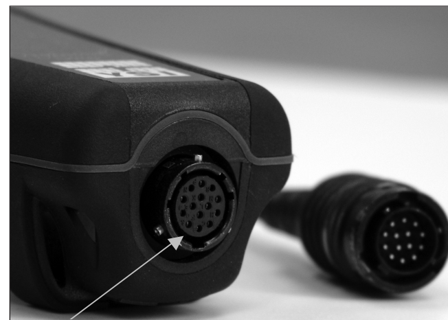
Figure 4. Notez le connecteur à clé.
